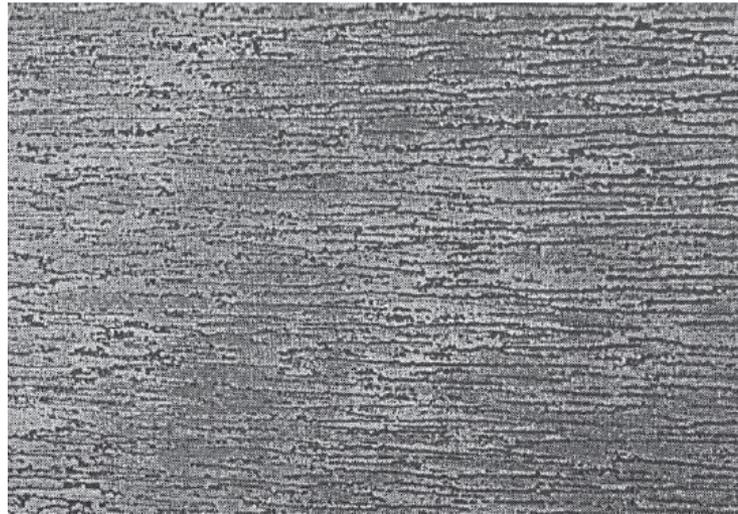
*Рис. 5. Спекл-структура, полученная в свободном пространстве в случае освещения щелевого участка на матовом стекле при дополнительной компьютерной обработке*
